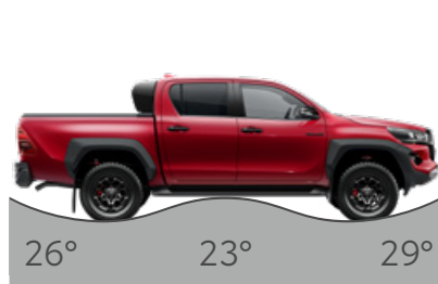
Zadný nájazdový uhol Prechodový uhol Predný nájazdový uhol
