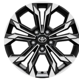
17" zliatinové disky kolies, pneumatiky 215/55 R17
