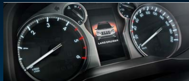
Skvelo čitateľné optitronové ukazovatele znižujú únavu zraku pri jazdách v noci. Namiesto bežného podsvietenia číselníka používajú samostatné LED diódy pre všetky čísla a ručičky.
