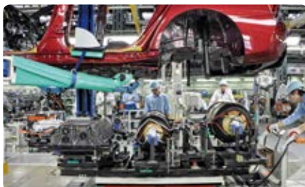
Montáž vysokotlakových zásobníkov vodíka a palivových článkov spolu s meničom napätia
