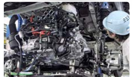
Montáž regulátora napájania spolu s elektromotorom vo výške prednej nápravy Mirai
