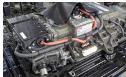
Modul palivových článkov pripravený na montáž
