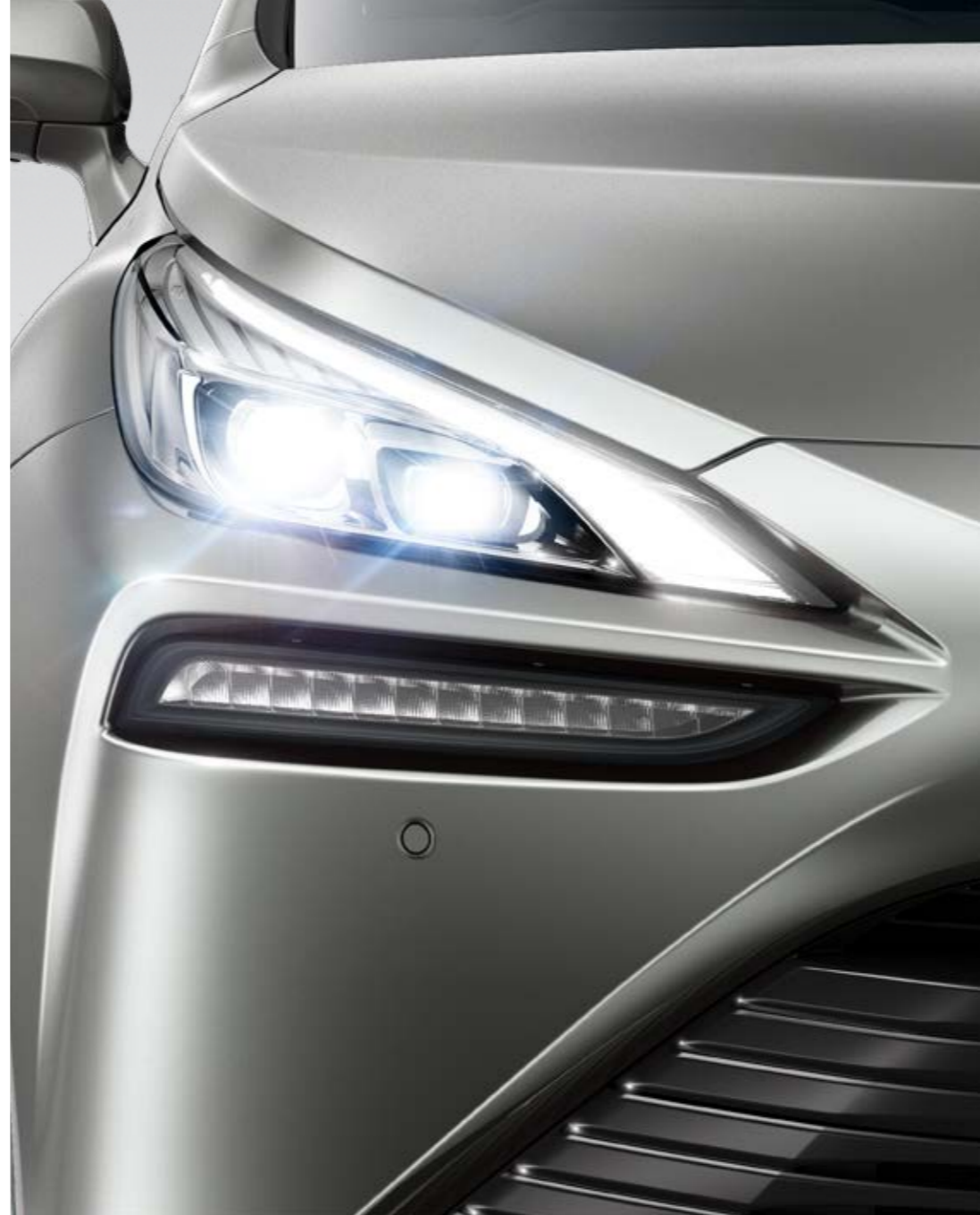
Bi-LED predné svetlomety s funkciou adaptívnych diaľkových svetiel (AHS) aktivujú jednotlivé LED segmenty podľa potreby.
